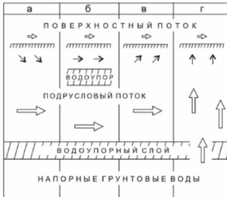
Рис. 3. Фильтрационный режим в грунте типичных нерестилищ лососевых рыб и вертикальная зональность подземных водоносных горизонтов: а – инфильтрация речных вод в дно русла, б – участки с горизонтальной фильтрацией воды в речном грунте, в – выходы вод подруслового потока, г – выходы напорных грунтовых вод (из Леман, 2003)
